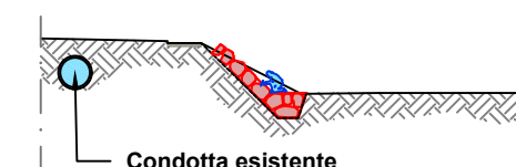
INTASAMENTO CON TERRA - PIANTUMAZIONE DI TALEE
