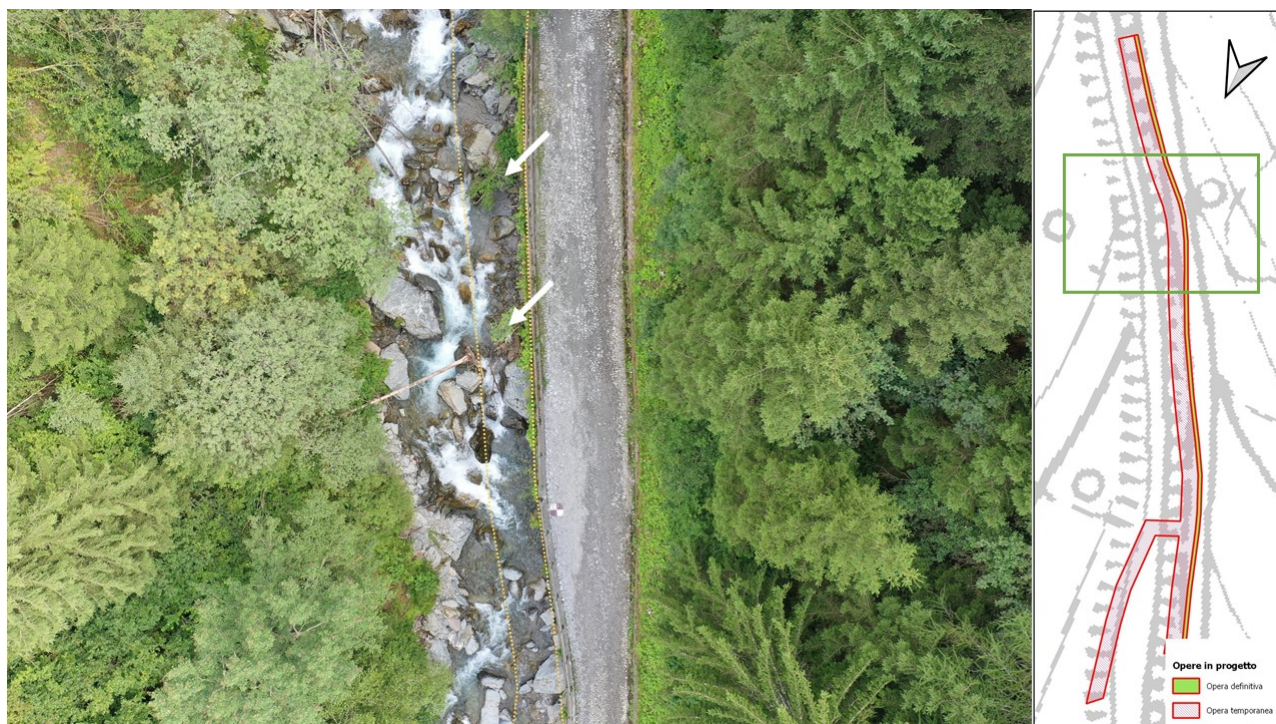
Figura 12: quarto tratto di intervento. Pista di cantiere affiancata alla pista esistente da consolidare.
