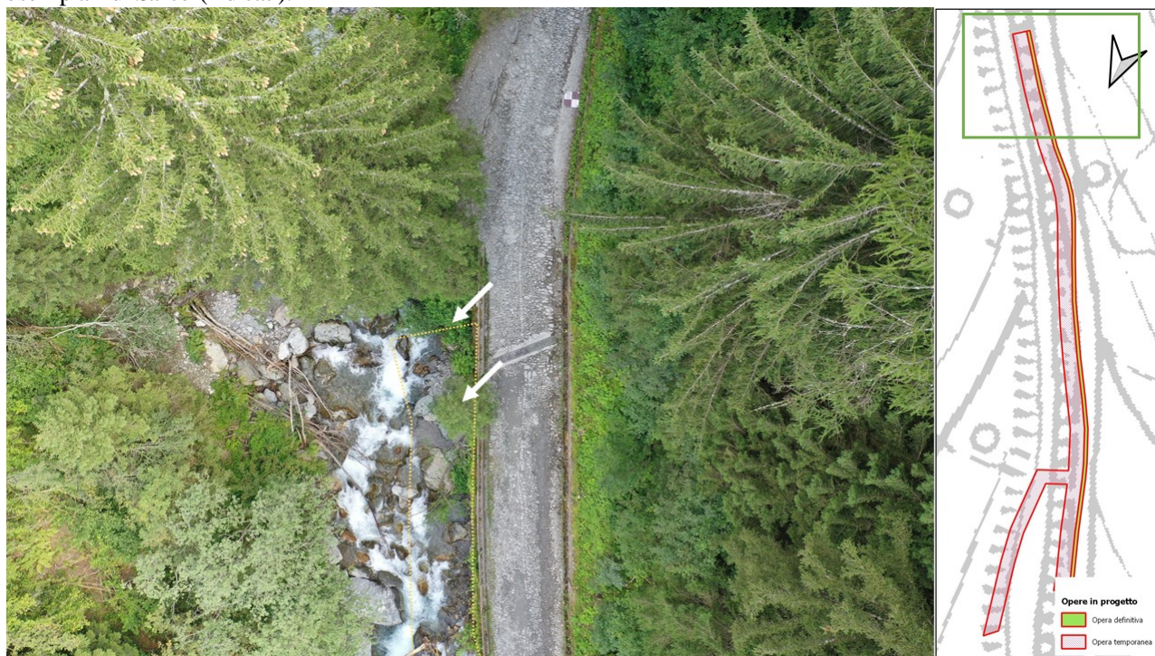
Figura 13: quinto tratto di intervento. Pista di cantiere affiancata alla pista esistente da consolidare.
