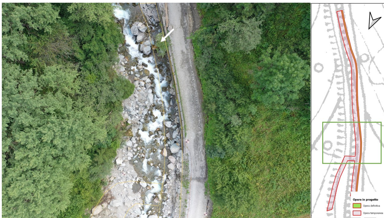
Figura 10: secondo tratto di intervento. Pista di cantiere affiancata alla pista esistente da consolidare.
