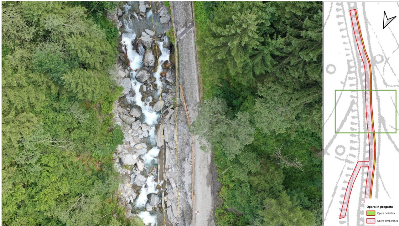
Figura 11: terzo tratto di intervento. Pista di cantiere affiancata alla pista esistente da consolidare.
