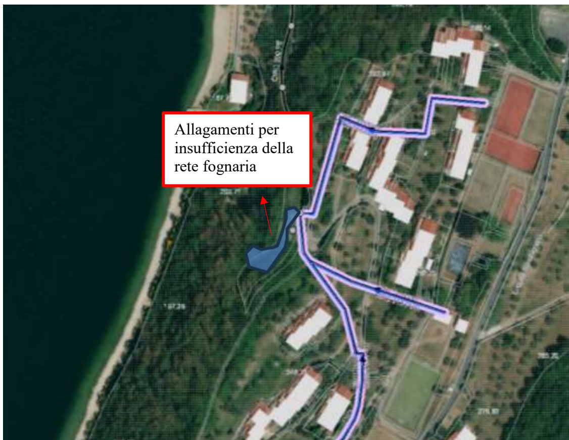
Figura 15: Criticità insufficienza della rete fognaria delle acque miste, località Villaggio SITI.
