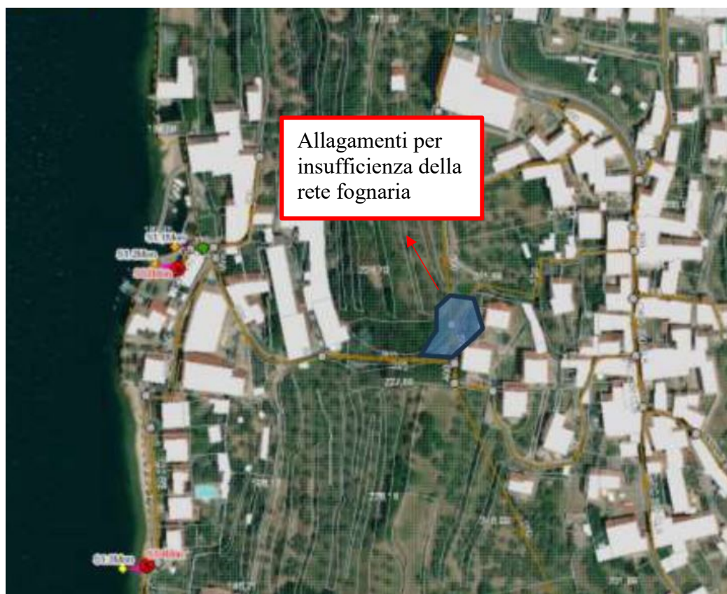
Figura 14: Criticità insufficienza della rete fognaria delle acque miste, località Siviano.
