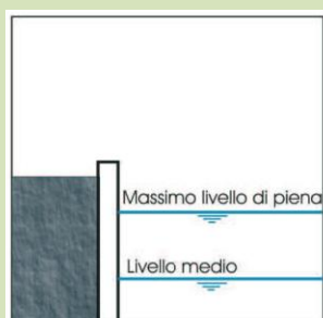
Passaggi faunistici in scatolari idraulici 1) Costruzione di due banchine laterali poste tra il letto di magra e quello inondato in periodo di piena 2) Costruzione di un marciapiede al di sopra delle acque di massima piena 3) Costruzione di una passerella in legno al di sopra del livello di massima piena - (da www.arpa.piemonte.it )
