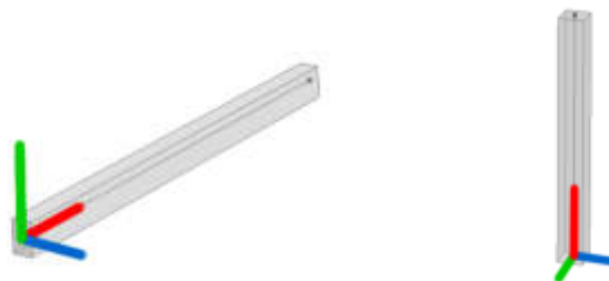
Terne locali dell'elemento asta (trave e pilastro)
