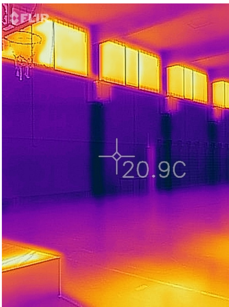
Immagine termografica dall'interno con evidenziazione della struttura in cemento armato
