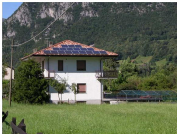
Fig 62. L'inserimento di pannelli fotovoltaici su un abitazione in un paesaggio di montagna. I pannelli sono posizionati sulla falda più visibile dalla strada per problemi di esposizione. In questo caso è da valutare la possibilità di installare i pannelli a terra. Nel caso di installazione su falda essa dovrà essere particolarmente curata, adottando colori simili a quelli della copertura.
