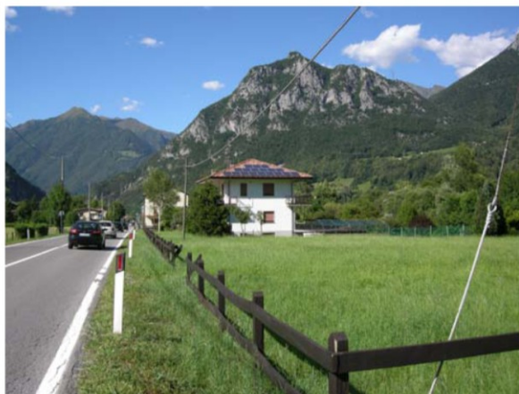
Fig 62. L'inserimento di pannelli fotovoltaici su un abitazione in un paesaggio di montagna. I pannelli sono posizionati sulla falda più visibile dalla strada per problemi di esposizione. In questo caso è da valutare la possibilità di installare i pannelli a terra. Nel caso di installazione su falda essa dovrà essere particolarmente curata, adottando colori simili a quelli della copertura.
