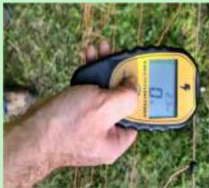
Figura B6.2 - Controllo della corrente lungo una recinzione.
