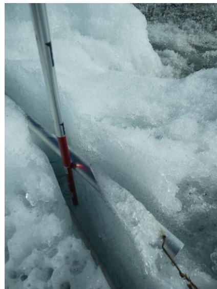
P5 al 19/09/2025 Dettaglio del punto in cui si è individuato l'ultimo spezzone infisso scollegato dagli altri completamente emersi
