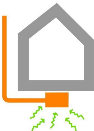
Figura 13: depressione del sottosuolo tramite pozzetto.
