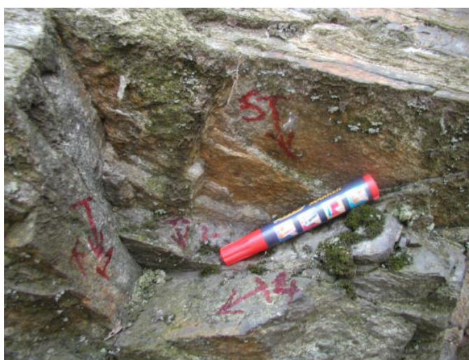
Famiglie di discontinuità riconoscibili in loco
