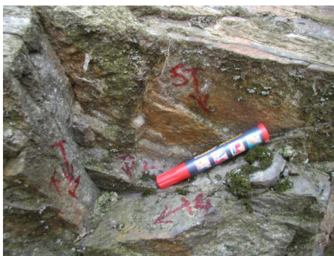
Famiglie di discontinuità riconoscibili in loco
