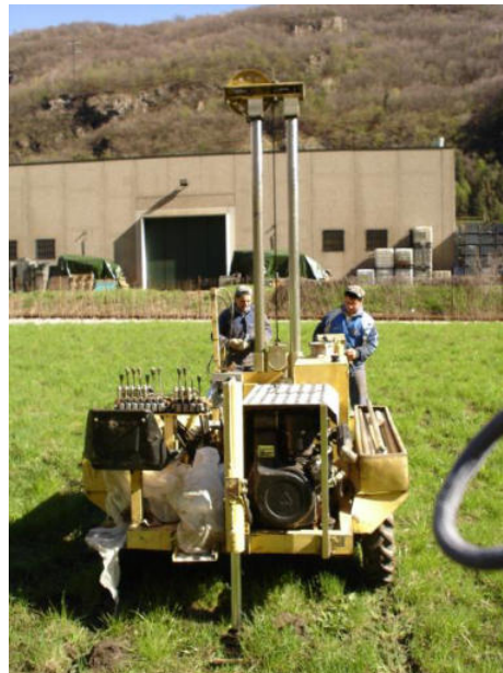
Foto 2: Esecuzione prova penetrometrica P2
