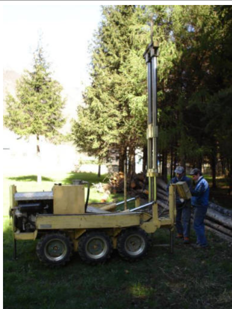
Foto 3: Esecuzione prova penetrometrica P4
