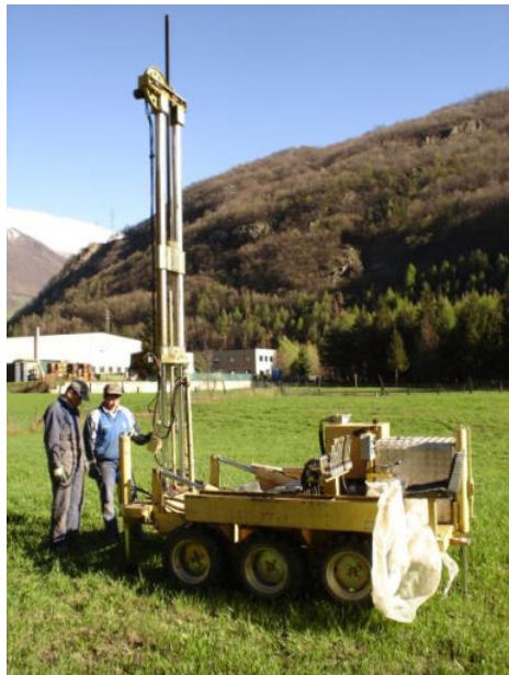
Foto 1: Esecuzione prova penetrometrica P1
