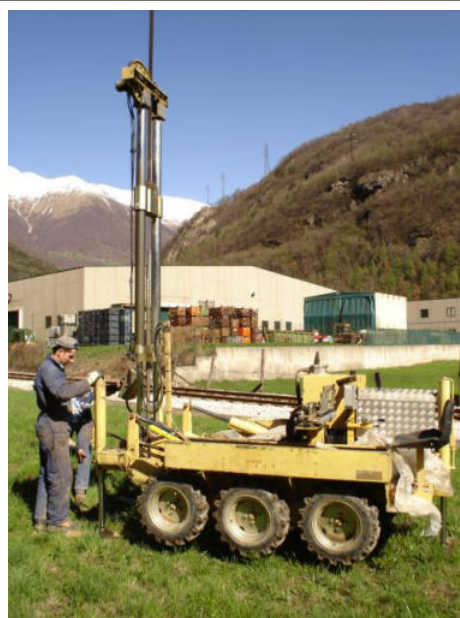
Foto 4: Esecuzione prova penetrometrica P5
