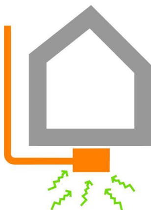
Figura 13: depressione del sottosuolo tramite pozzetto.
