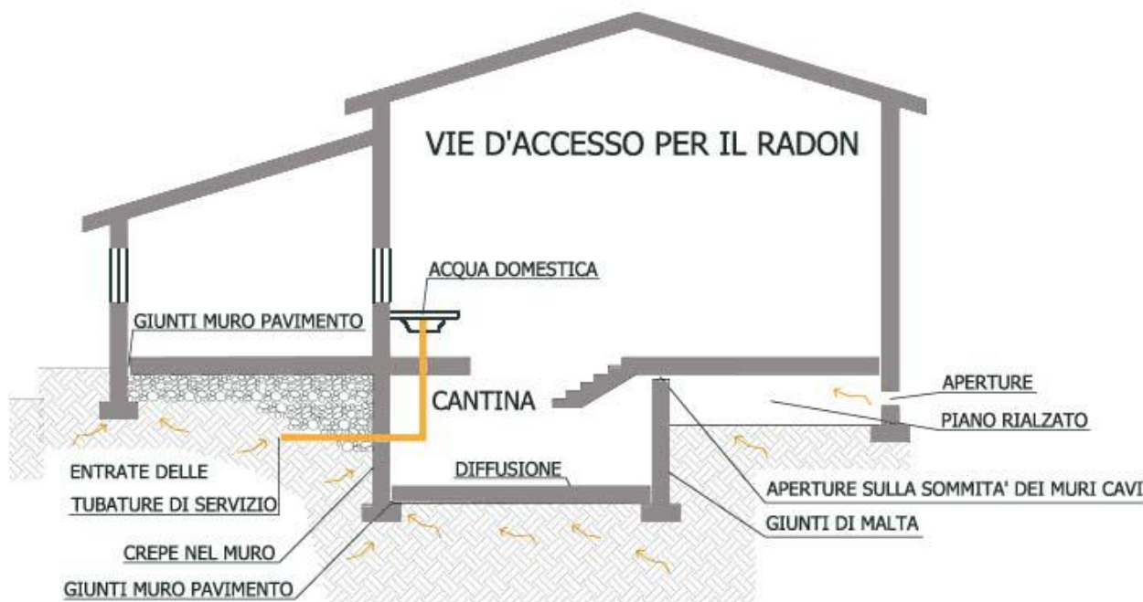
Figura 5: vie d'accesso per il radon
