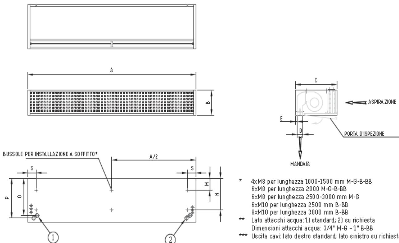
Cassa di alloggiamento in lamiera di acciaio verniciata di colore bianco RAL 9016 contenente potente ventilatore centrifugo, griglia di aspirazione metallica microforata per cattura polvere, rimovibile con semplice panno o con un aspirapolvere.
