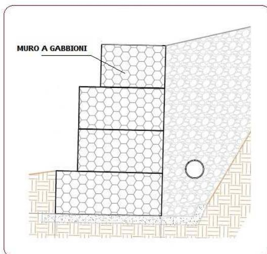
Il filo utilizzato nella produzione dei gabbioni (a basso tenore di carbonio) può essere rivestito, con Galfan (lega eutettica di Zinco-Alluminio – 5%) secondo [UNI EN 15646](#) in relazione alle caratteristiche di durata dell'opera e del grado di aggressività ambientale.
