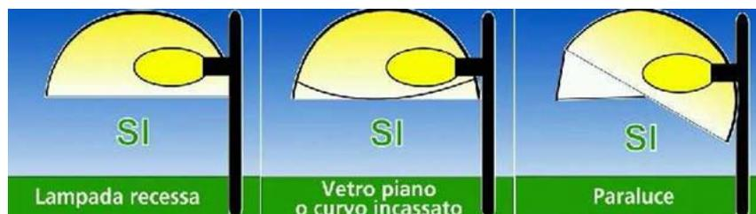
Figura 2 Tipologie di apparecchi conformi alla legge n.17/2000
