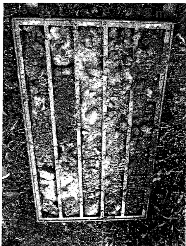
FOTO 3-4: CAROTE SONDAGGIO MECCANICO DA 0,0 A -10,0 m
