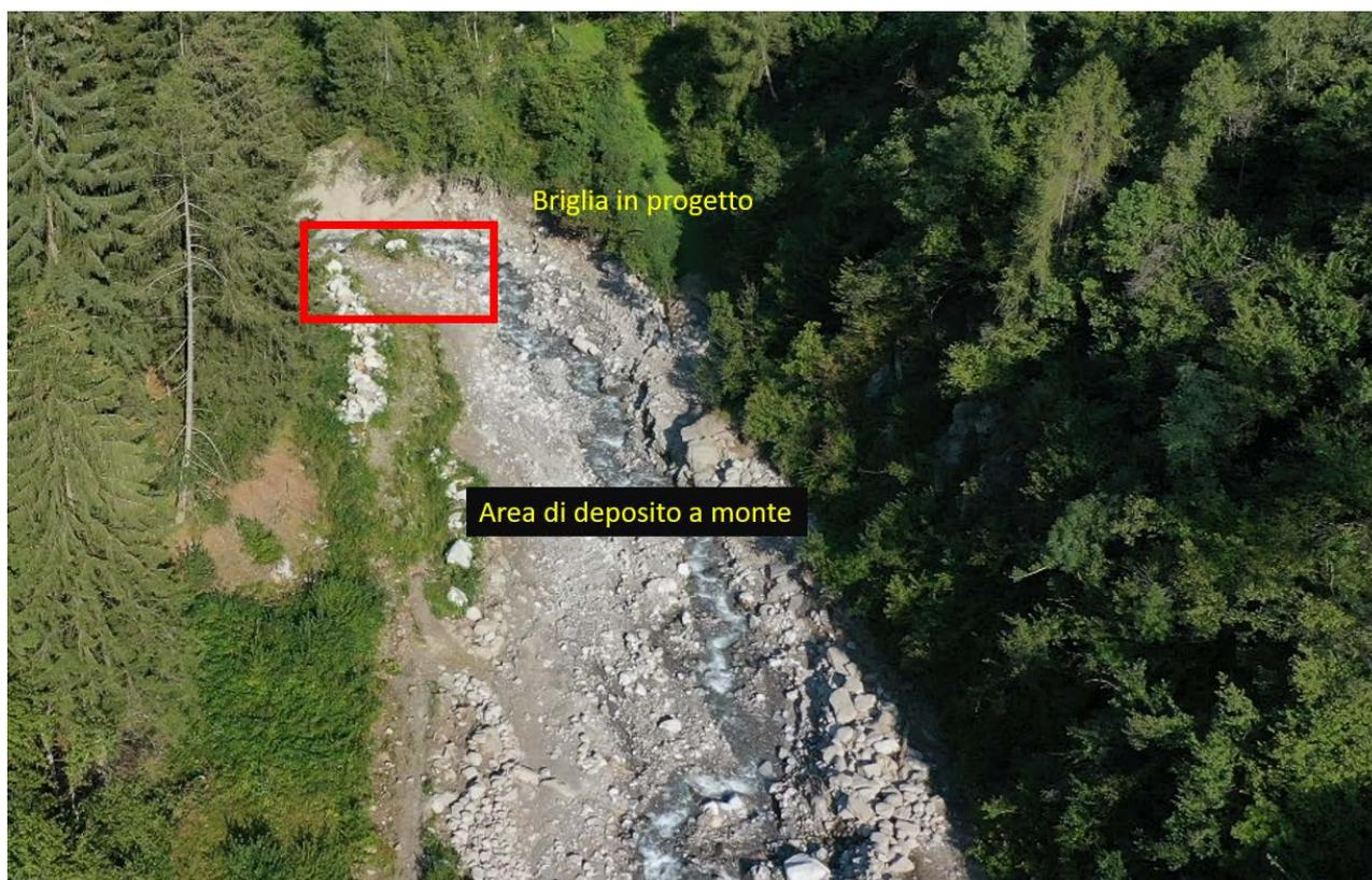
*Figura 14: Area dove andrà realizzata la briglia di progetto e zona di accumulo a monte di essa. Quest'area dovrà favorire il deposito dei materiali più grossolani.*
