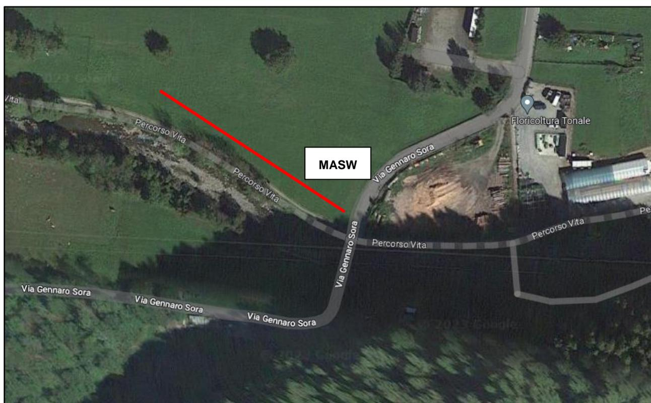
L'acquisizione di campagna è stata condotta con il sismografo Pasi 16S24-U, con geofoni verticali e orizzontali di 4,5 Hz spazati di 5 m con offset a 10 m, l'energizzazione è costituita da una mazza del peso di 10 Kg.
