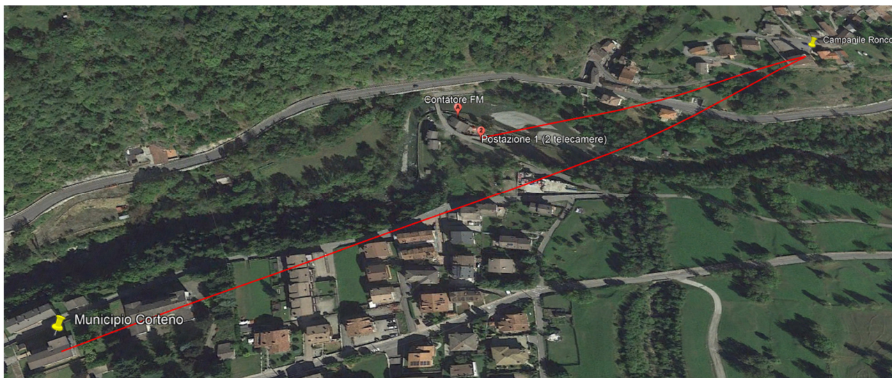
Figura 1 Ponte radio con rilancio verso il municipio da chiesa Ronco
